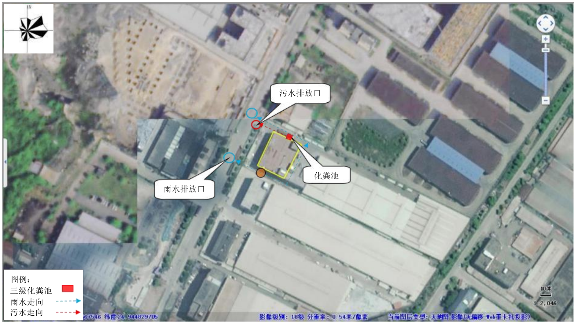
附图 5 项目厂区雨污水走向示意图
