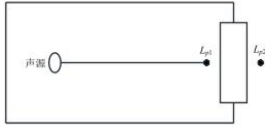
图4-2 室内声源等效为室外声源图例
