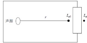
图 4-1 室内声源等效为室外声源图例
