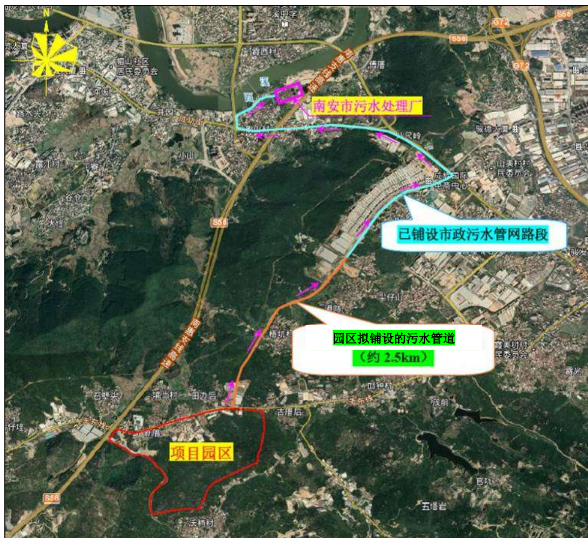
图6-1 区域市政污水管网工程示意图
